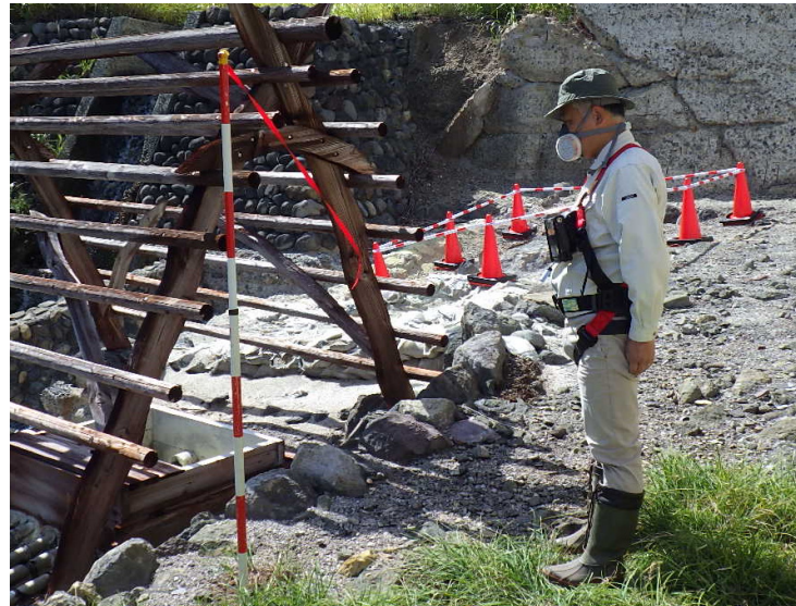
防毒マスクと硫化水素・酸素検知警報器（胸部分に装着） と吹き流しの状況
